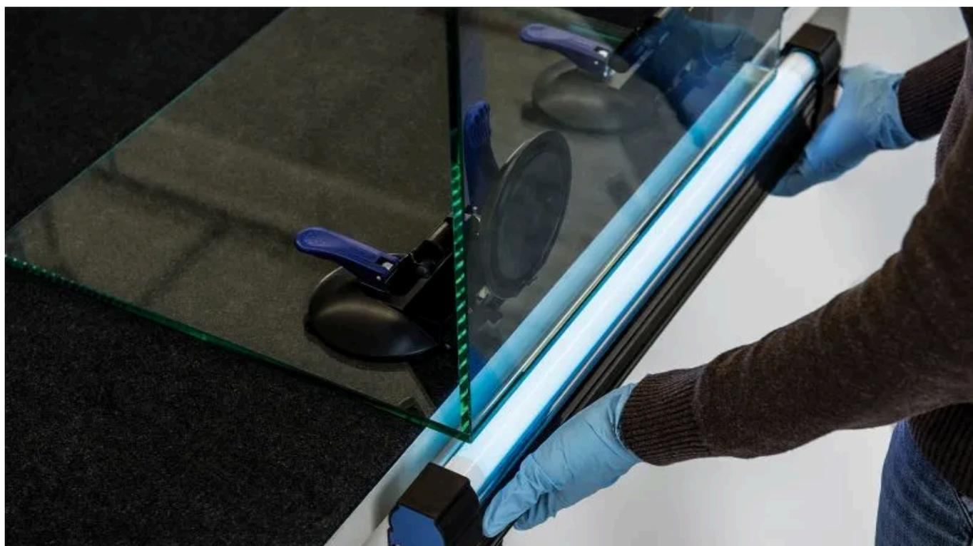
L'une des dernières étapes est le durcissement de la colle avec une lampe UV adaptée. Choisissez toujours vos lampes UV en fonction de la taille de la surface du collage afin d'obtenir une exposition uniforme et simultanée de toute la surface de collage. Cela permet à la colle de durcir de manière uniforme et empêche l'accumulation involontaire de tensions inégales dans le collage, ce qui pourrait entraîner une défaillance de l'assemblage.
